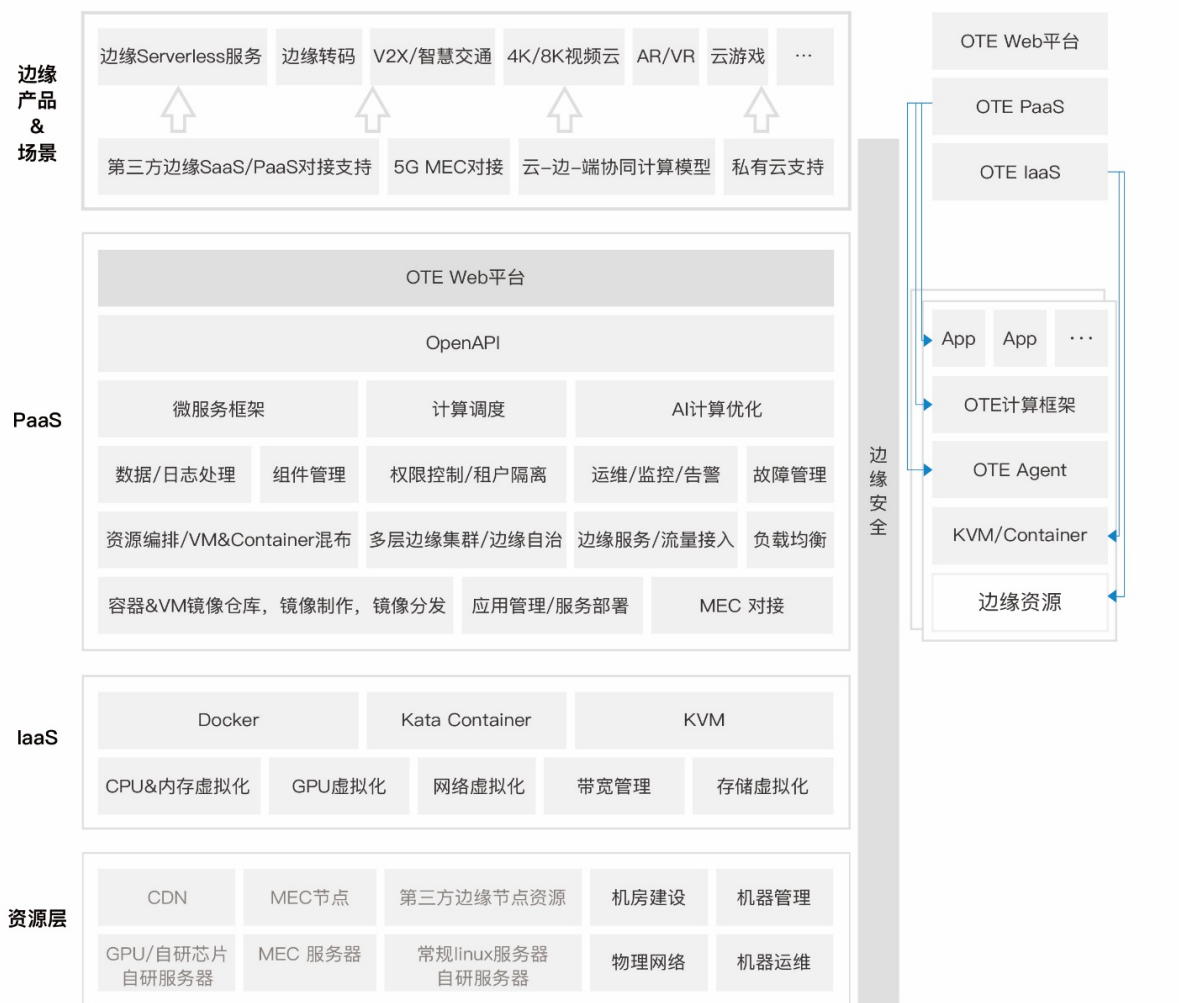
图 5 OTE 边缘计算架构
